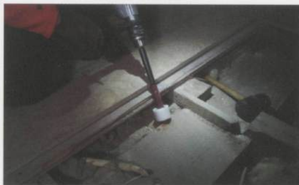
Boring ten behoeve van een dendrochronologische datering. Kasteel Huize Ruurlo, juli 2014 (foto: auteur)
